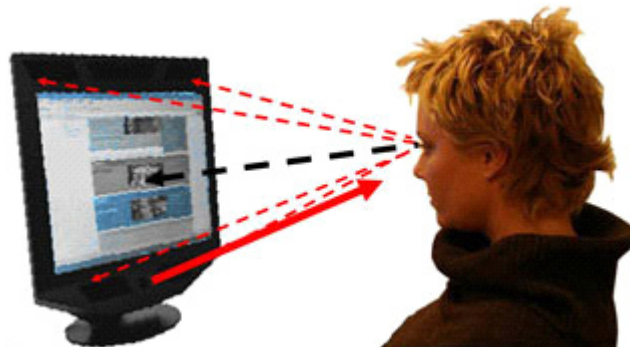
rysunek 1. Schemat odbijania promieni podczerwonych w przypadku stacjonarnego eye trackera
