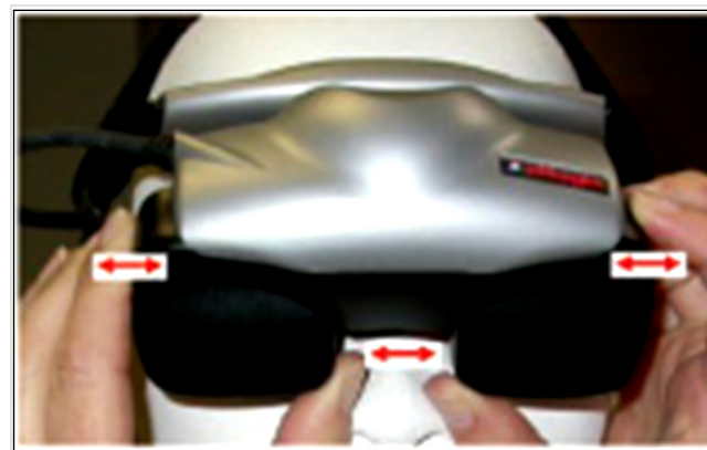
Obrazek 27. Regulacja rozstawu wyświetlaczy hełmu tak, aby źrenice każdego z oczu były na środku wyświetlacza.
