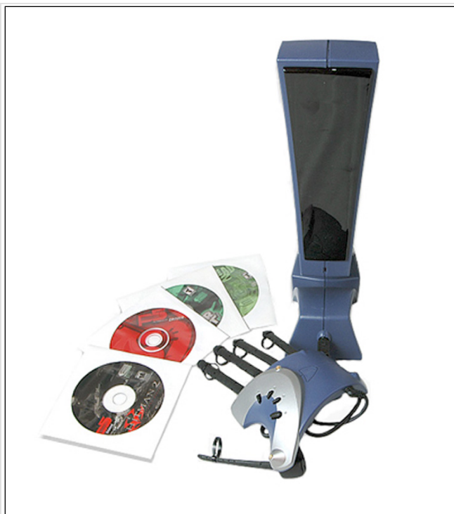
Obrazek 30. rękawica P5 Glove wraz z kolumną na podczerwień służącą do wykrywania ruchu rękawicą w płaszczyźnie XY.
