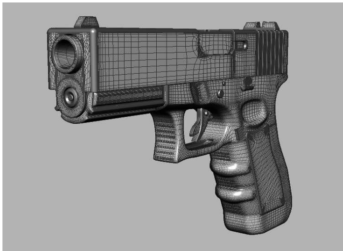
Rysunek 1.1. Model pistoletu Glock utworzony metodą wygładzania ścianek uproszczonej siatki (zobacz rozdział 6)
