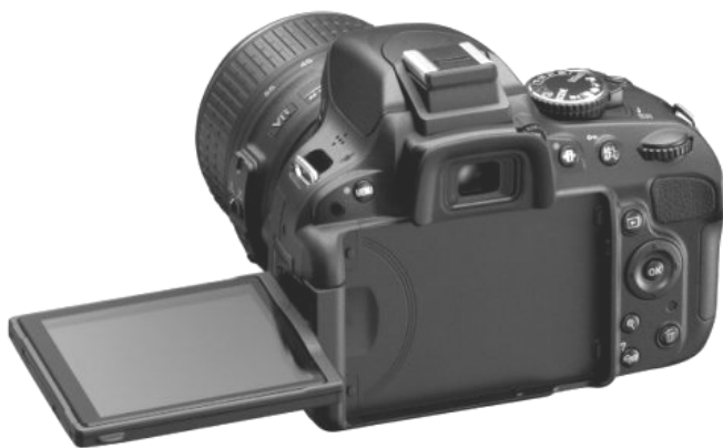
Rysunek 6.6. Odchylany ekran podglądu w aparacie cyfrowym bardzo ułatwia kadrowanie zdjęcia
