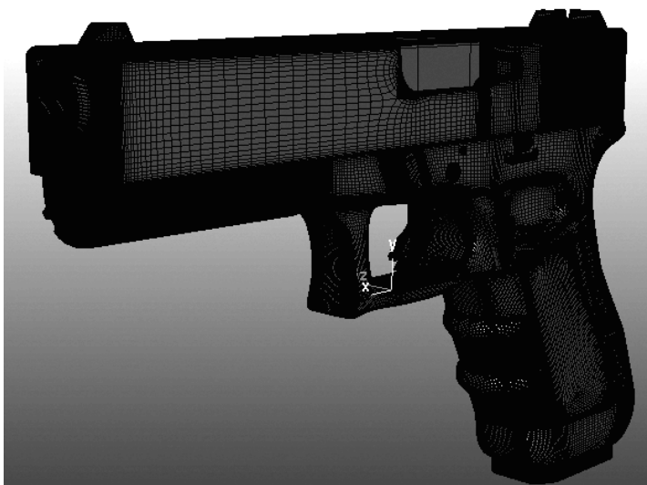
Rysunek 3.6. Siatka wysokopoligonowa (hi-poly) - ok. 1,1 mln ścianek
