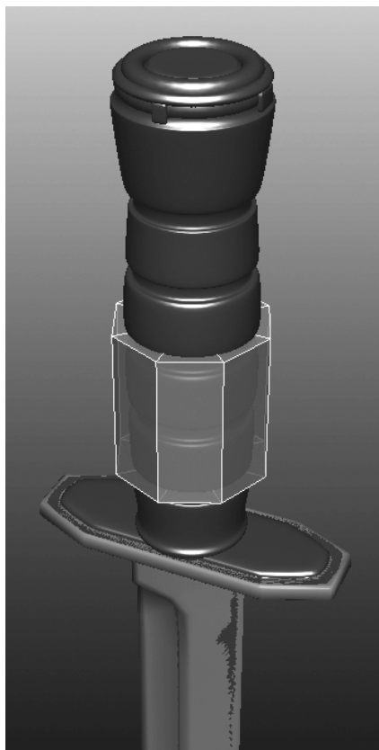
Rysunek 3.12. Tworzenie modelu niskopoligonowego rozpoczęte w oparciu o nowe bryły
