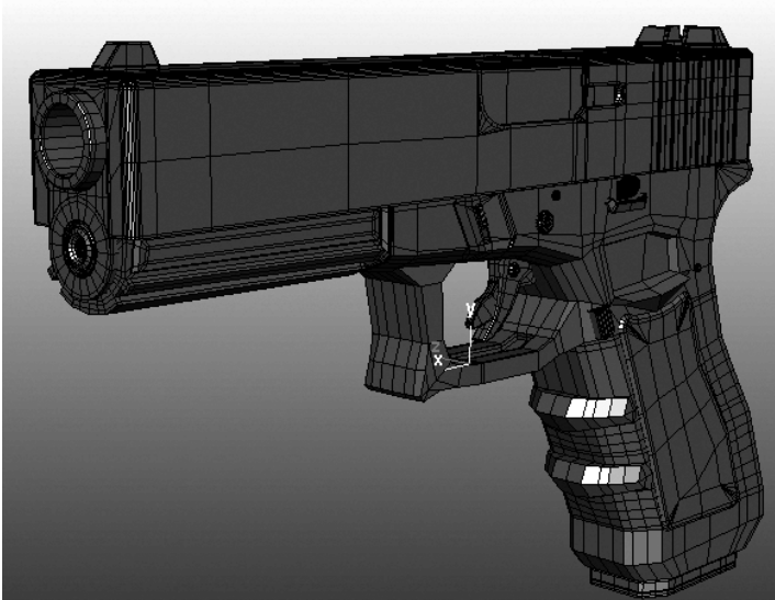
Rysunek 3.5. Siatka przygotowania do zagęszczenia (mid-poly) - ok. 30 tys. ścianek
