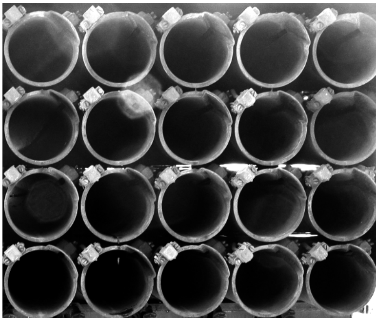
Rysunek 6.4. Przykład zdjęcia, do którego zakradł się efekt flary i prześwietlenie krawędzi
