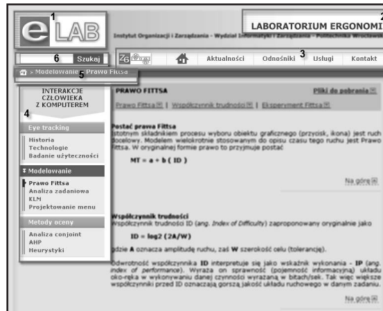
Rys. 1. Wzorcowy rezultat testu Kruga dla wybranej podstrony serwisu Laboratorium Ergonomii Politechniki Wrocławskiej ( http://www.ergonomia.ioz.pwr.wroc.pl/hci--modelowanie-prawo_fitsa.php ). Wyróżnione bloki: 1. Logo; 2. Nazwa; 3. Główne kategorie; 4. Nawigacja lokalna; 5. Aktualne położenie; 6. Wyszukiwarka
